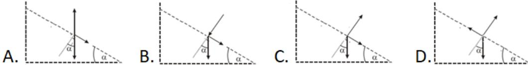
4 No esquema do exercício anterior, se a força de atrito entre o bloco e o plano for de  $5 \text{ N}$ , o ângulo  $\alpha = 30^\circ$  e a massa do bloco for de  $2 \text{ kg}$ , tendo em conta  $g = 10 \text{ m/s}^2$ , o bloco deslisa com uma aceleração de:
